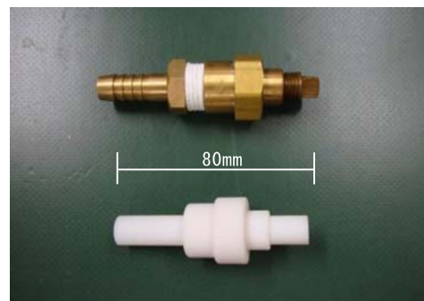
図 2-18 オリジナルのノズル(上)と 3D プリンター製のノズル(下) (流れは左から右)
