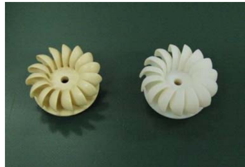
図 2-14 ランナ (左:オリジナル, 右: 3D プリンターによる試作品)
