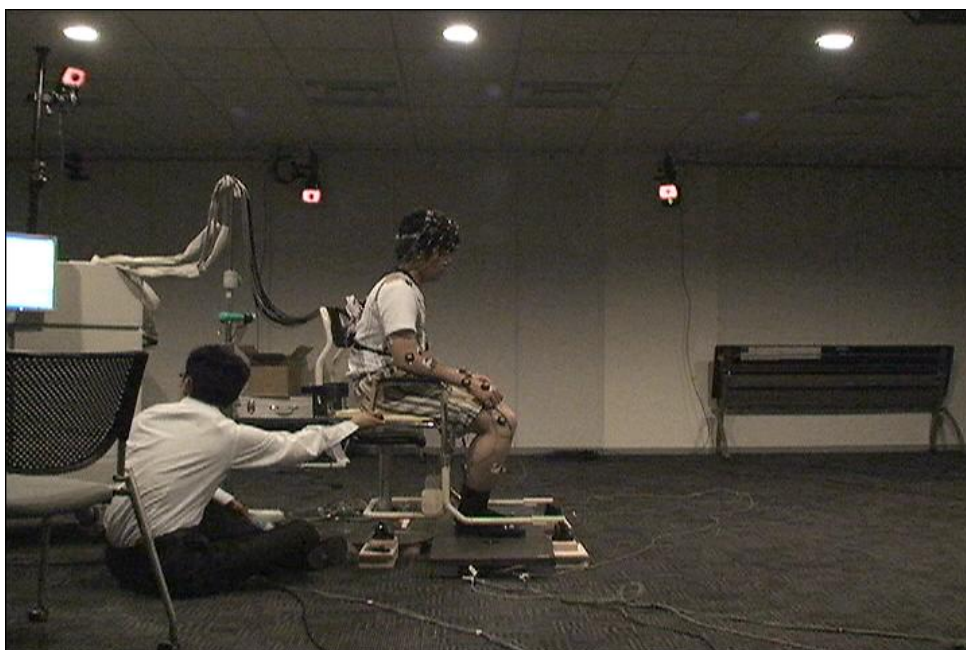
図 50 3次元動作解析装置、筋電位計、NIRSによる実験風景
