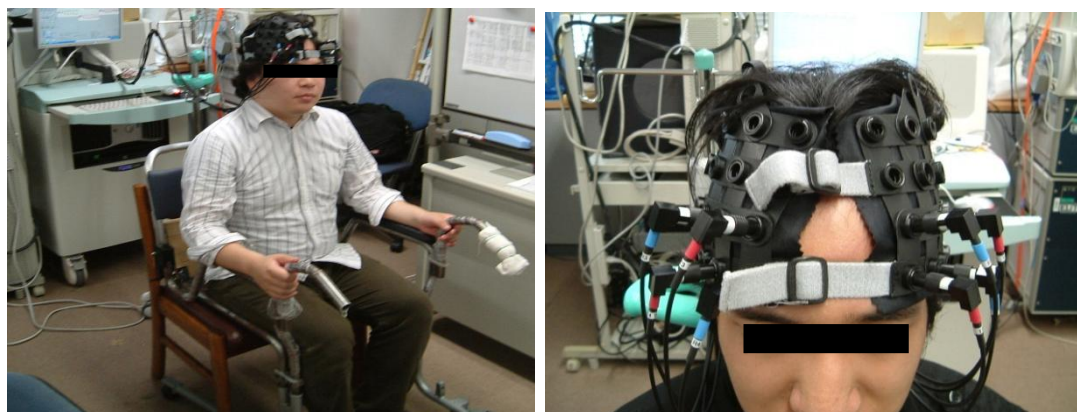
図 44 実験風景と NIRS のプローブ配置
