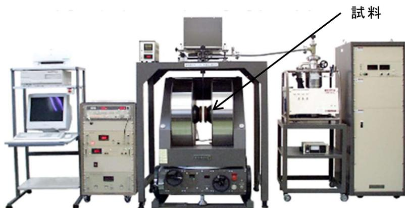
図2.2.1.1 振動試料型磁力計の装置<sup>10,11)</sup>。
