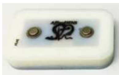
Fig.6.3.1 アフォードセンス社製 VitalgramCTセンサの外観
