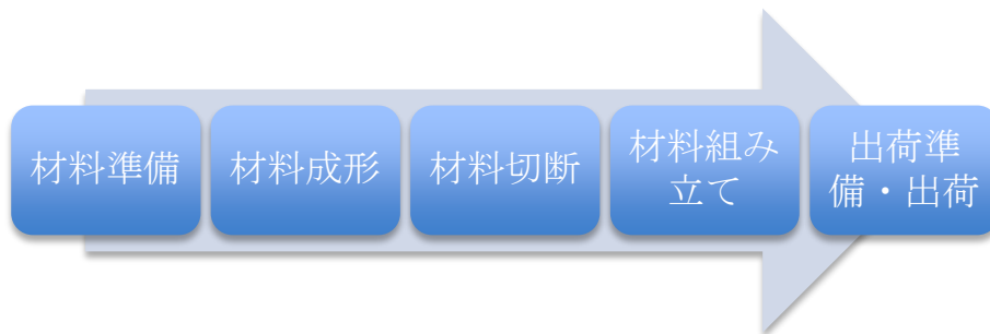
図 4.26 C 社における製造プロセス
