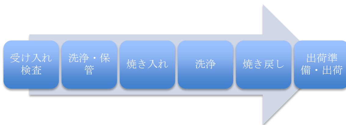
図 4.13 B 社における製造プロセス
